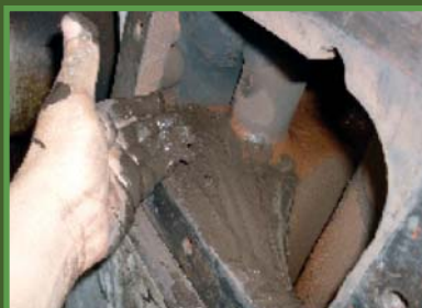
Efecto desincrustación en Cilindros motriz Campo PAYOA
