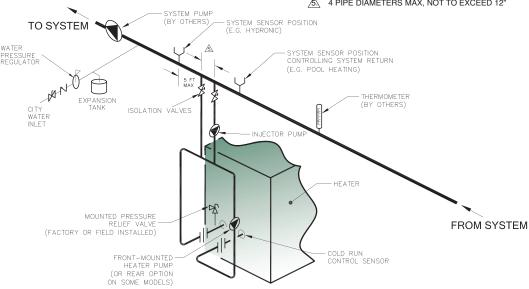
\* ITEMS REQUIRED FOR COLD WATER RUN OPERATION ARE SHOWN. OTHER STANDARD SYSTEM COMPONENTS HAVE BEEN OMITTED FOR CLARITY.
